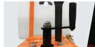
SYSTEME DE BLOCAGE DE LA PROFONDEUR DE COUPE
